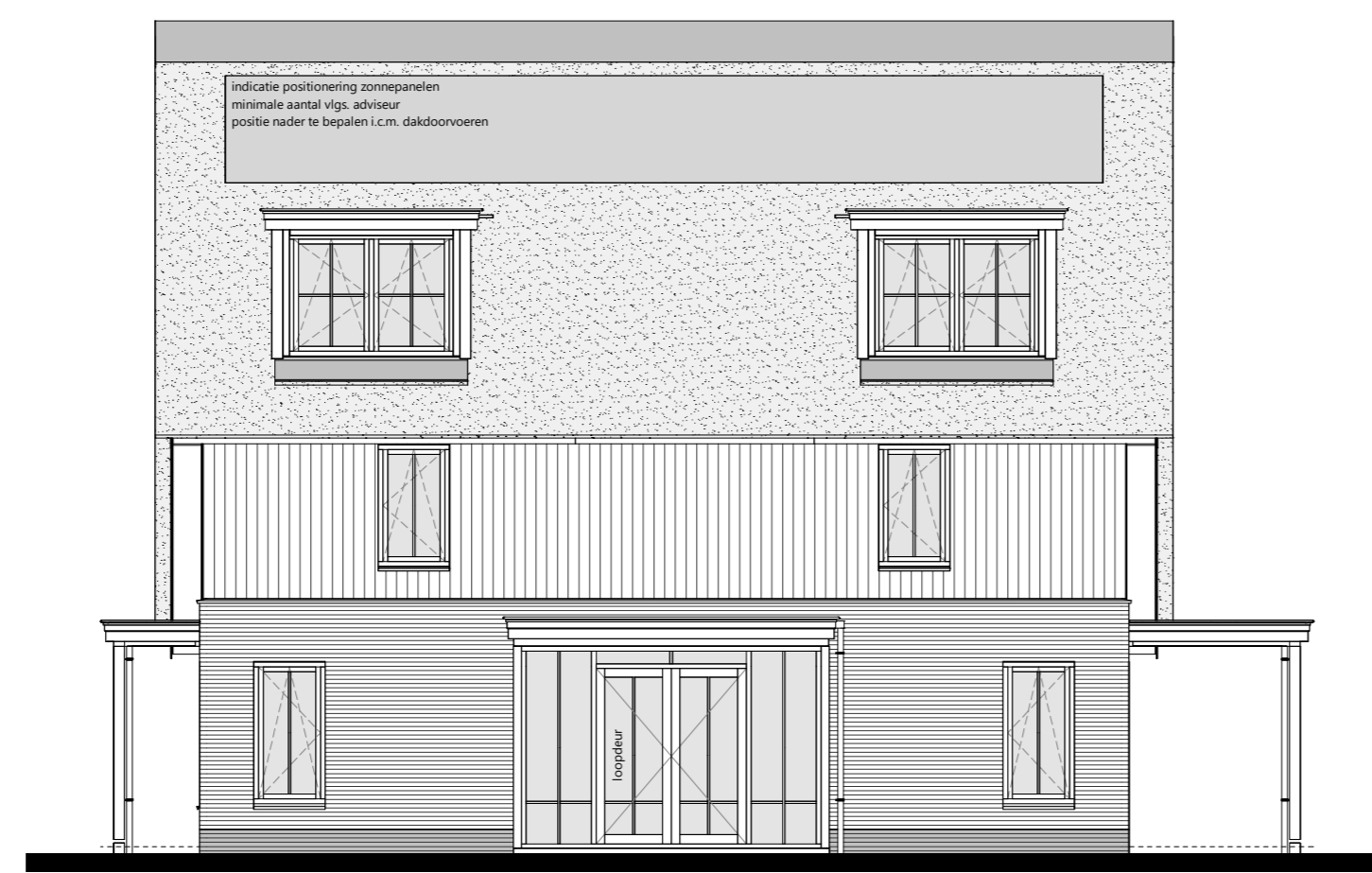
rechtergevel 1 : 100 optie: veranda voorgevel 1,20 x 6,30 m optie: veranda achtergevel 1,20 x 6,30 m optie: dakkapel(re) rechtergevel 2,40 x 6,30 m optie: zonnepanelen - aantal vlg. aanbieder
