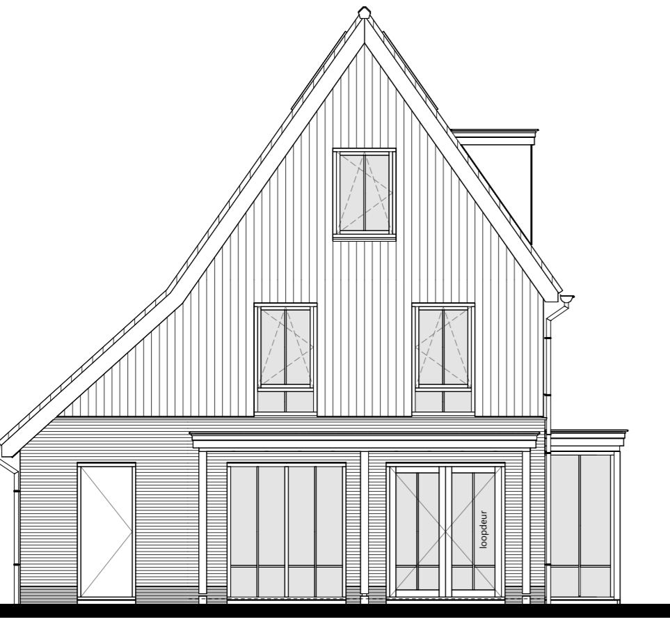
achtergevel 1 : 100 optie: veranda achtergevel 1,20 x 6,30 m optie: veranda achtergevel 2,40 x 6,30 m optie: dakkapel linkergevel
