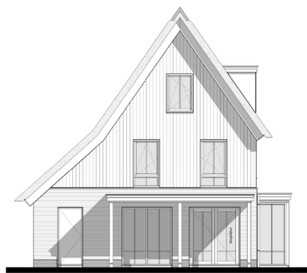
achtergevel 1 : 100 optie: veranda achtergevel 1,20 x 6,30 m optie: veranda achtergevel 2,40 x 6,30 m optie: dakkapel linkergevel
