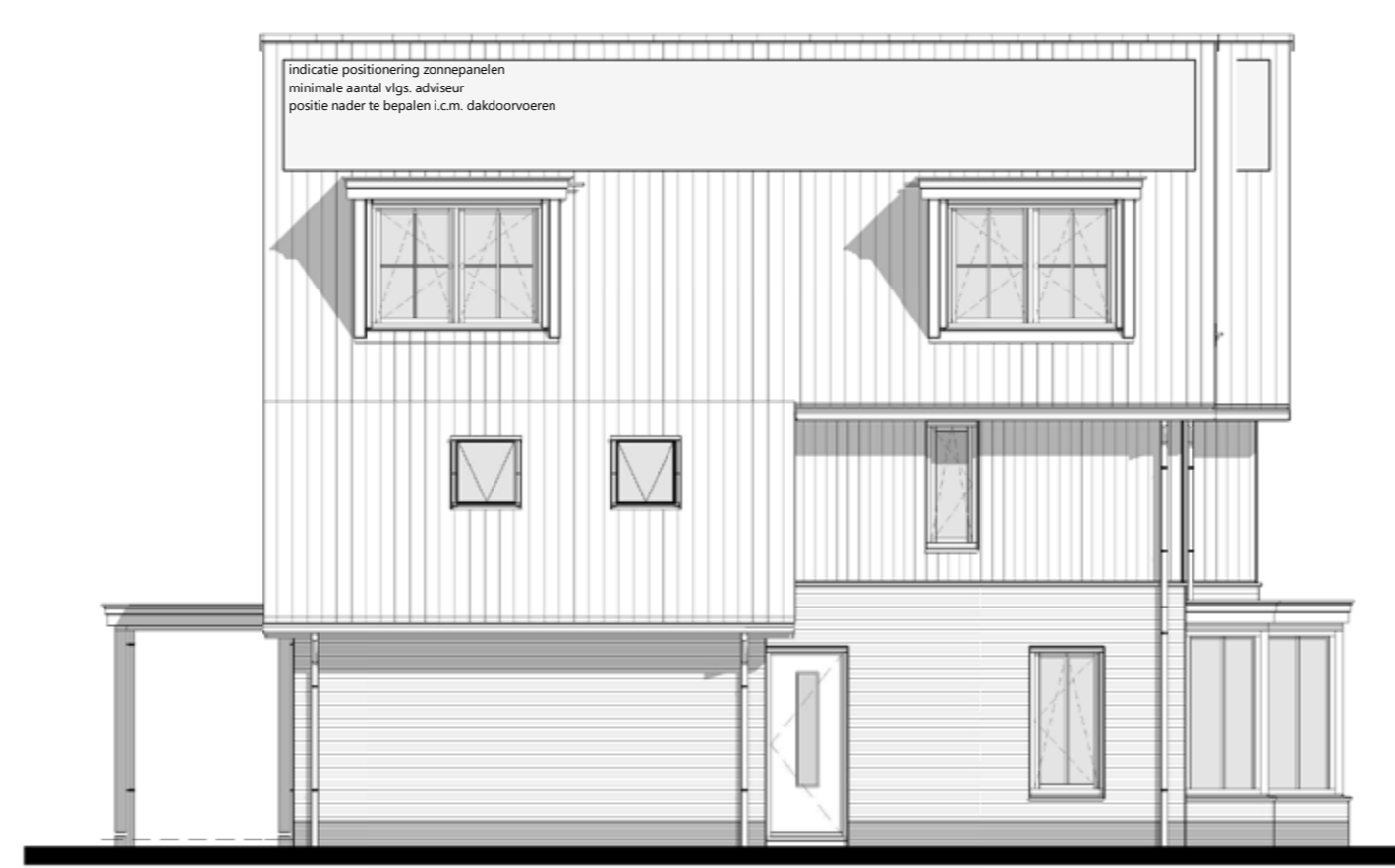
linkergevel 1 : 100 optie: veranda achtergevel 1,20 x 5,06 m optie: veranda achtergevel 2,40 x 5,06 m optie: 2x dakraam zijgevel 0,94 x 1,40 m optie: dakkapel(ten) zijgevel optie: zonnepanelen - aantal vlgs. aanbieder
