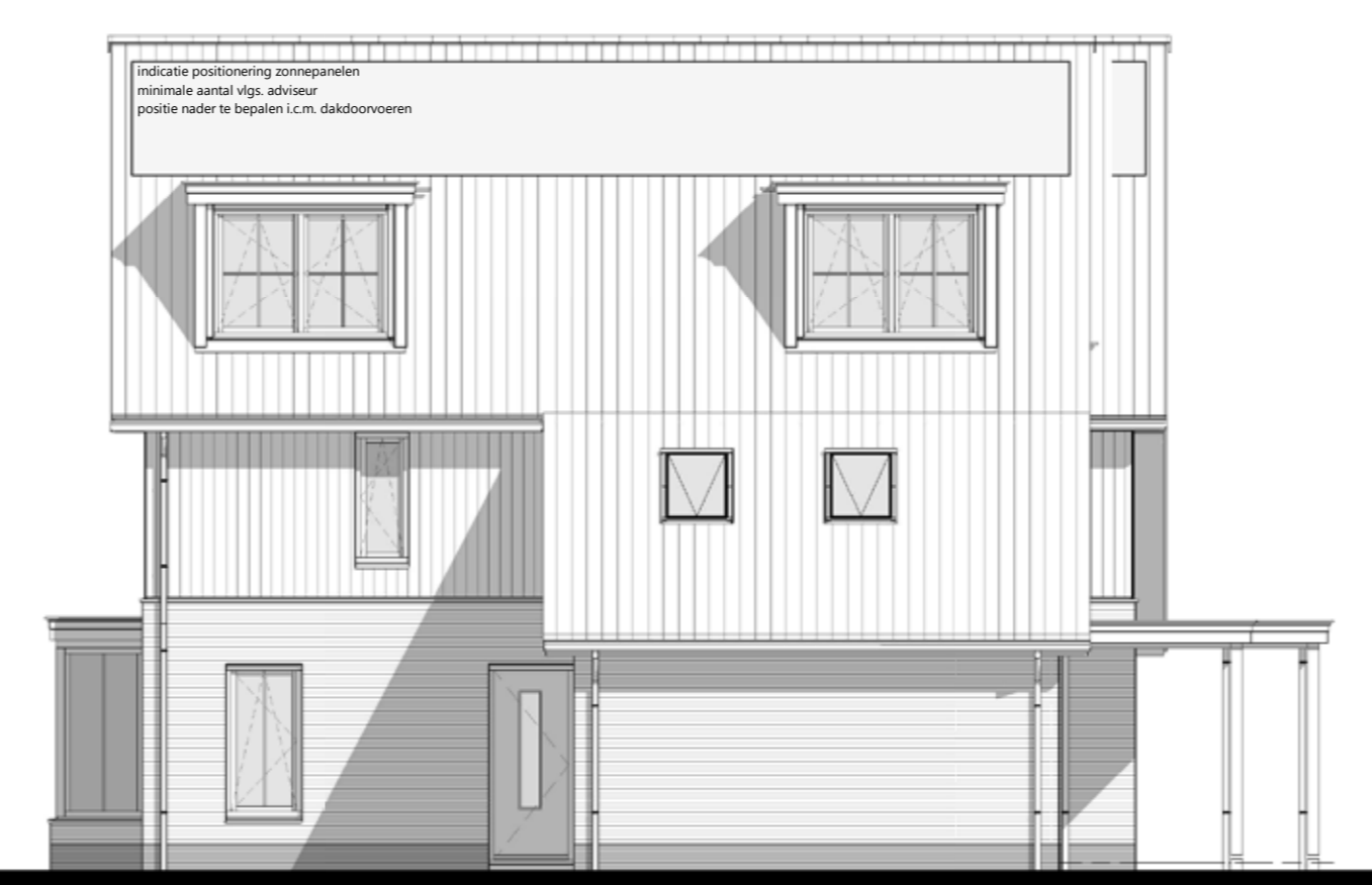
Rechtergevel 1 : 100 optie: veranda achtergevel 1,20 x 5,06 m optie: veranda achtergevel 2,40 x 5,06 m optie: 2x dakraam zijgevel 0,94 x 1,40 m optie: dakkapel(ten) zijgevel optie: zonnepanelen - aantal vlgs. aanbieder
