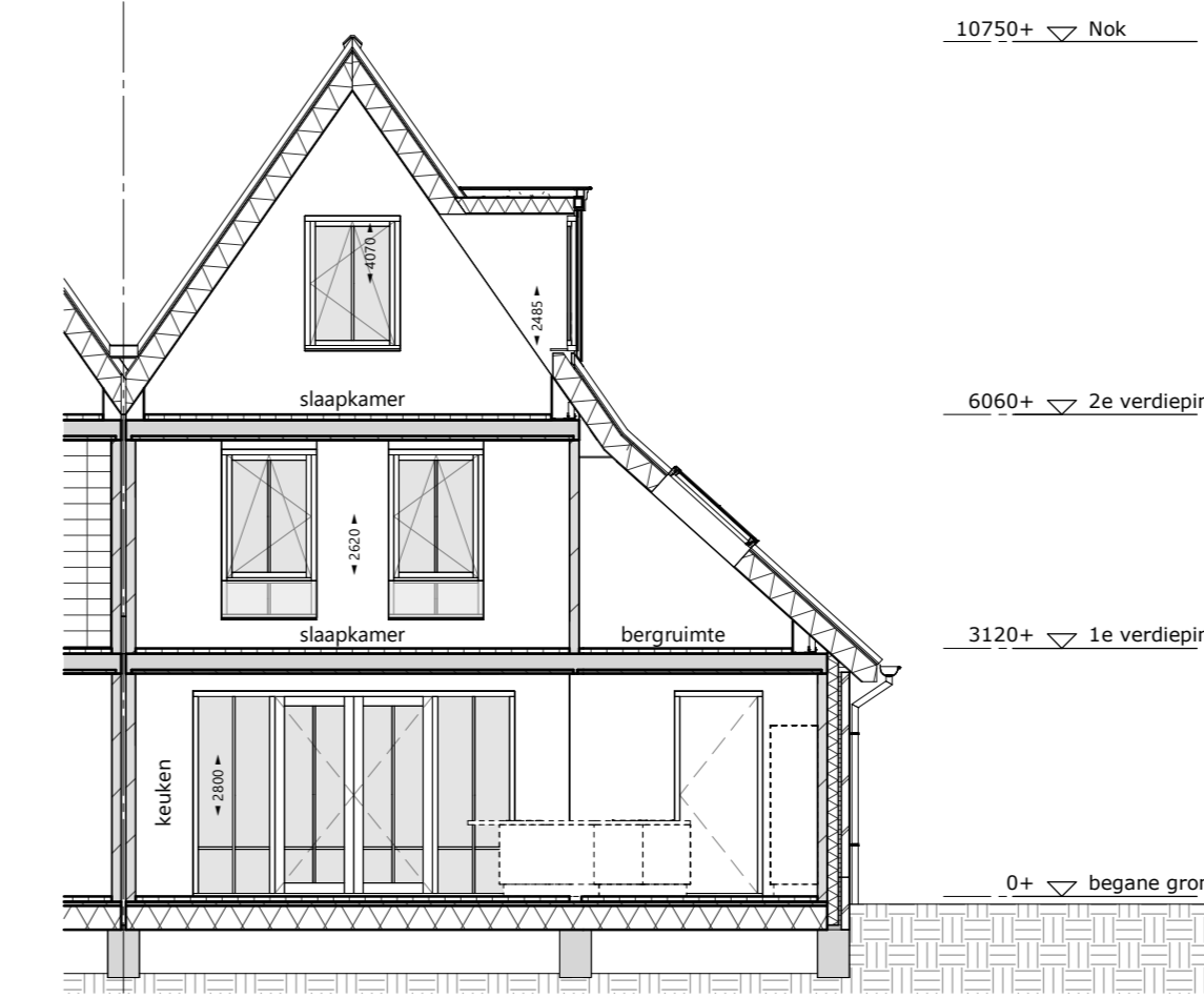
dwarsdoorsnede B 1 : 100 optie: uitbreiding keuken + compacte berging optie: aanbouw achtergevel 2,40 x 6,40 m optie: 2x dakraam zijgevel 0,94 x 1,40 m optie: dakkapel(ten) zijgevel
