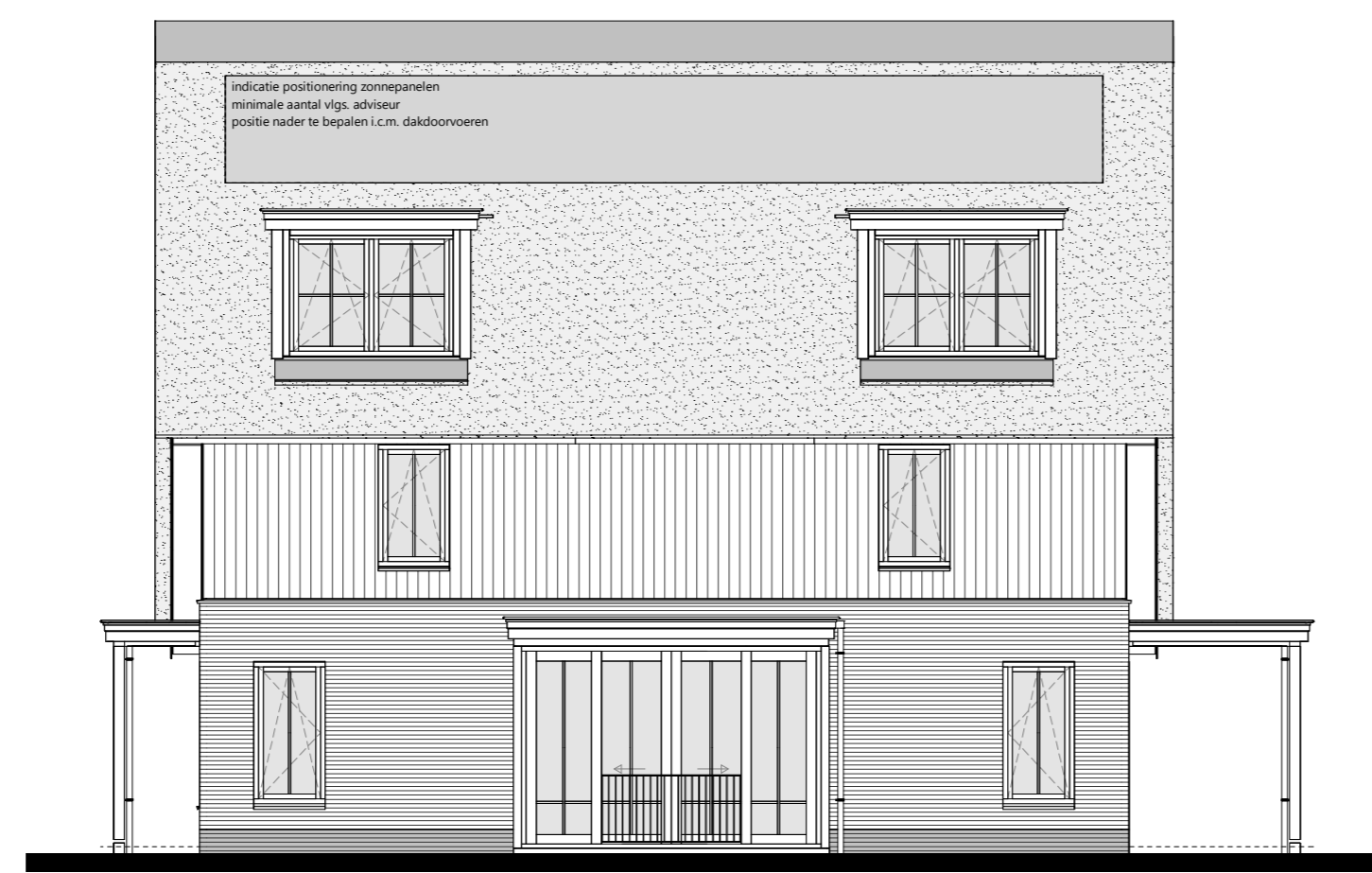
rechtergevel 1 : 100 optie: veranda voorgevel 1,20 x 6,30 m optie: veranda achtergevel 1,20 x 6,30 m optie: dakkapel(re) rechtergevel optie: veranda achtergevel 2,40 x 6,30 m optie: zonnepanelen - aantal vlg. aanbieder
