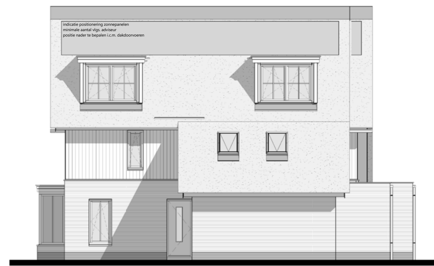
Rechtergevel 1 : 100 aanbouw achtergevel 2,40 x 6,40 m optie: 2x dakraam zijgevel 0,94 x 1,40 m optie: dakkapel(len) zijgevel optie: zonnepanelen - aantal vlgs. aanbieder
