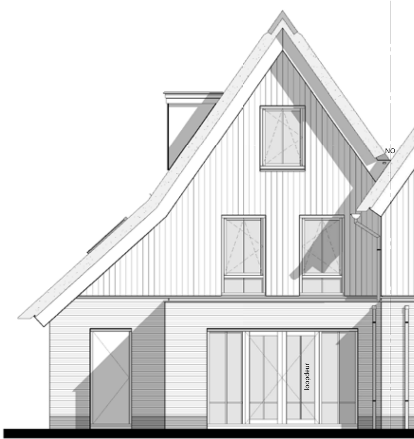
achtergevel 1 : 100 optie: aanbouw achtergevel 2,40 x 6,40 m optie: dakkapel(len) zijgevel optie: zonnepanelen - aantal vlgs. aanbieder
