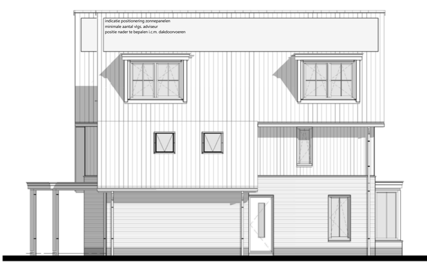
linkergevel 1 : 100 optie: veranda achtergevel 1,20 x 5,06 m optie: veranda achtergevel 2,40 x 5,06 m optie: 2x dakraam zijgevel 0,94 x 1,40 m optie: dakkapel(ten) zijgevel optie: zonnepanelen - aantal vlgs. aanbieder
