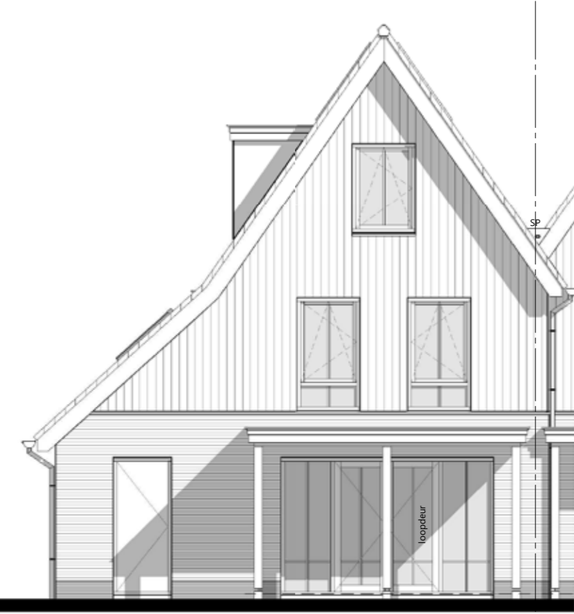
achtergevel 1 : 100 optie: veranda achtergevel 1,20 x 5,06 m optie: veranda achtergevel 2,40 x 5,06 m optie: dakkapel(ten) zijgevel
