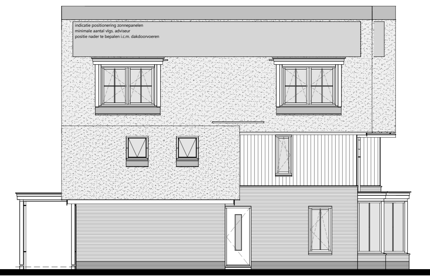
linkergevel 1 : 100 optie: veranda achtergevel 1,20 x 5,06 m optie: veranda achtergevel 2,40 x 5,06 m optie: 2x dakraam zijgevel 0,94 x 1,40 m optie: dakkapel(len) zijgevel optie: zonnepanelen - aantal vlgs. aanbieder
