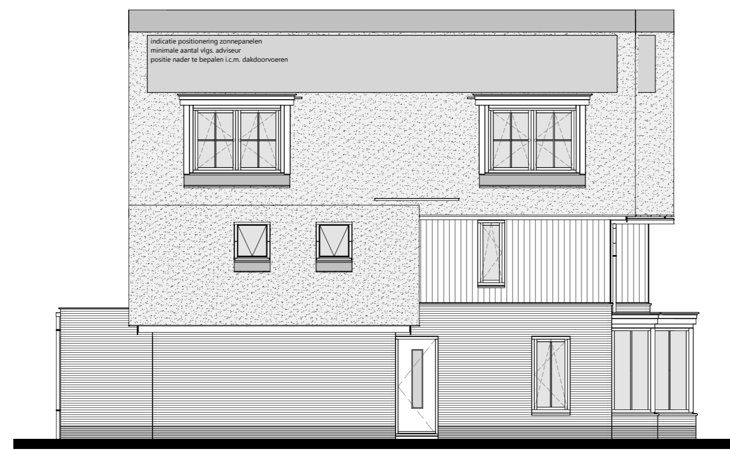
linkergevel 1 : 100 aanbouw achtergevel 2,40 x 6,40 m optie: 2x dakraam zijgevel 0,94 x 1,40 m optie: dakkapel(len) zijgevel optie: zonnepanelen - aantal vlgs. aanbieder
