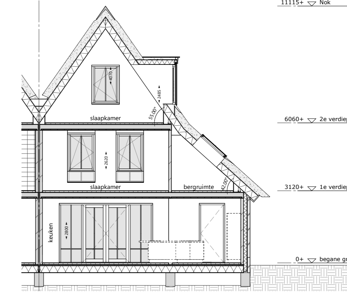
dwarsdoorsnede B 1 : 100 optie: uitbreiding keuken + compacte berging optie: aanbouw achtergevel 2,40 x 6,40 m optie: 2x dakraam zijgevel 0,94 x 1,40 m optie: dakkapel(len) zijgevel
