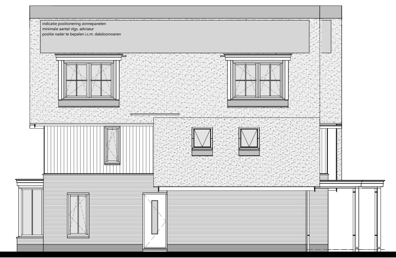
Rechtergevel 1 : 100 optie: veranda achtergevel 1,20 x 5,06 m optie: veranda achtergevel 2,40 x 5,06 m optie: 2x dakraam zijgevel 0,94 x 1,40 m optie: dakkapel(len) zijgevel optie: zonnepanelen - aantal vlg.s. aanbieder
