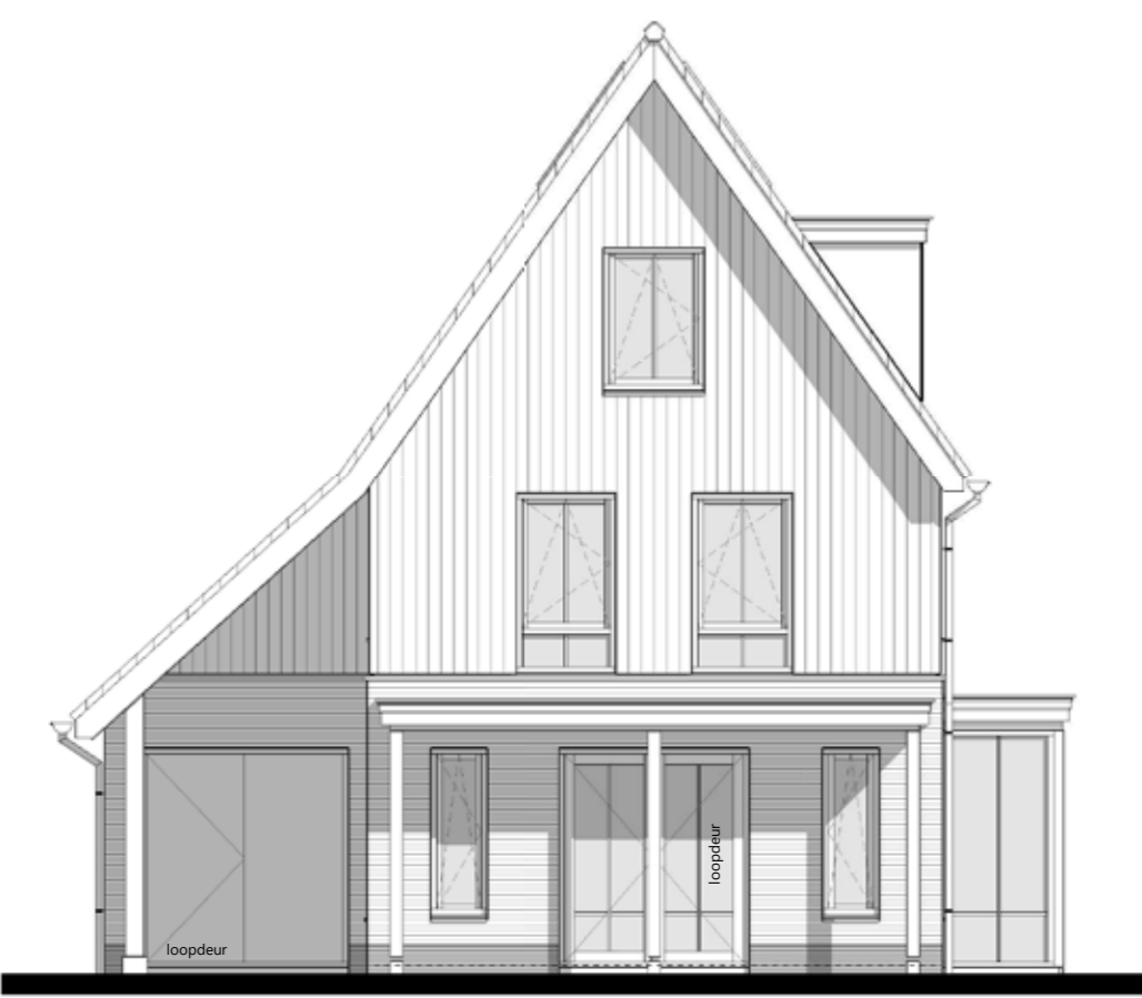
voorgevel 1 : 100 optie: veranda voorgevel 1,20 x 6,30 m optie: dakkapel rechtergevel
