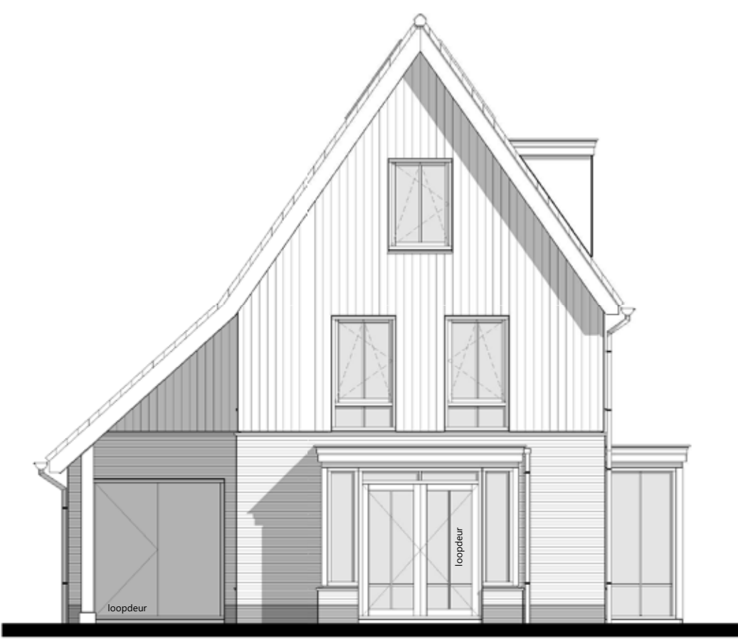
voorgevel 1 : 100 optie: erker voorgevel 1,20 x 3,80 m optie: dakkapel rechtergevel
