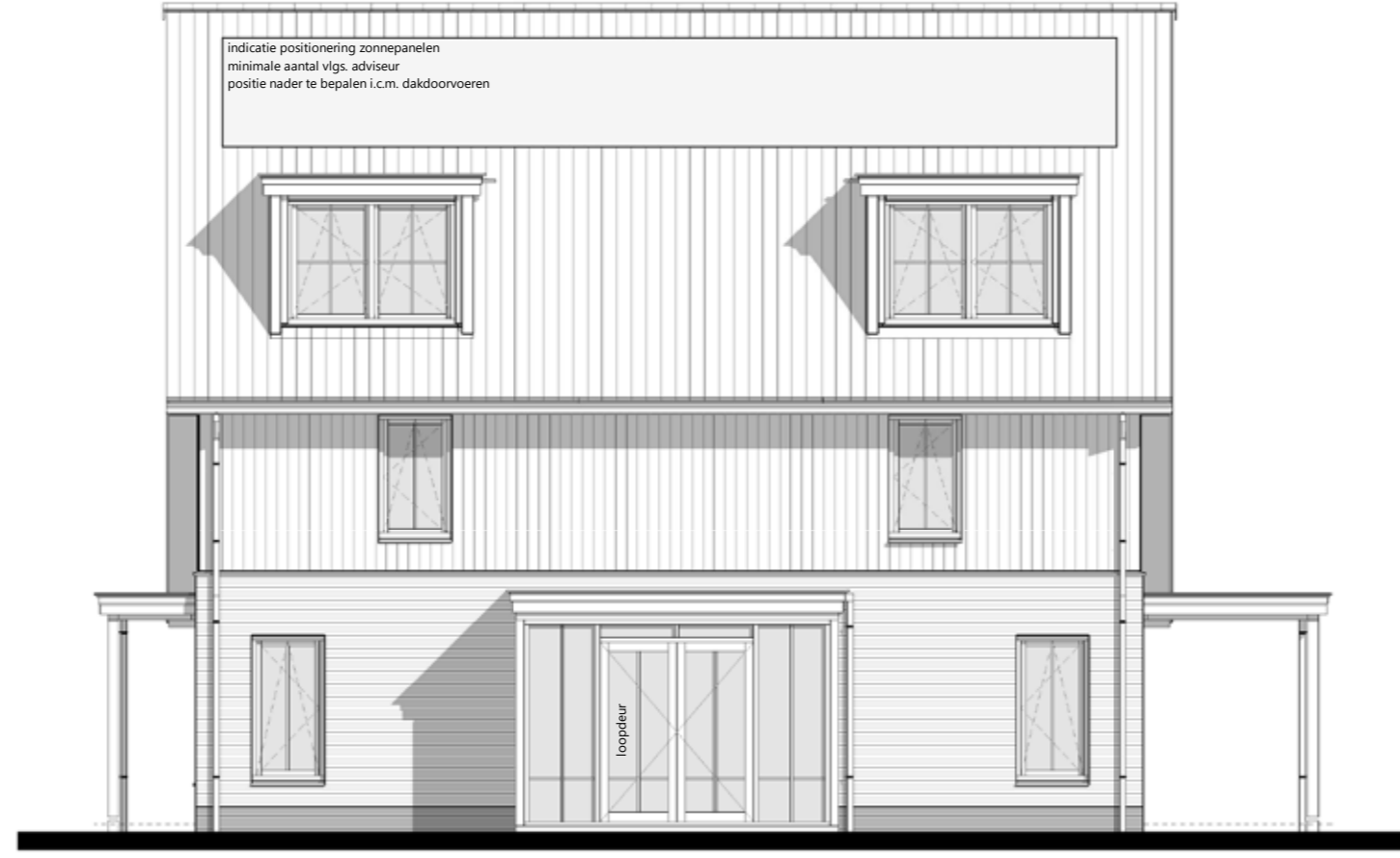
rechtergevel 1 : 100 optie: veranda voorgevel 1,20 x 6,30 m optie: veranda achtergevel 1,20 x 6,30 m optie: veranda achtergevel 2,40 x 6,30 m optie: zonnepanelen - aantal vlg. aanbieder
